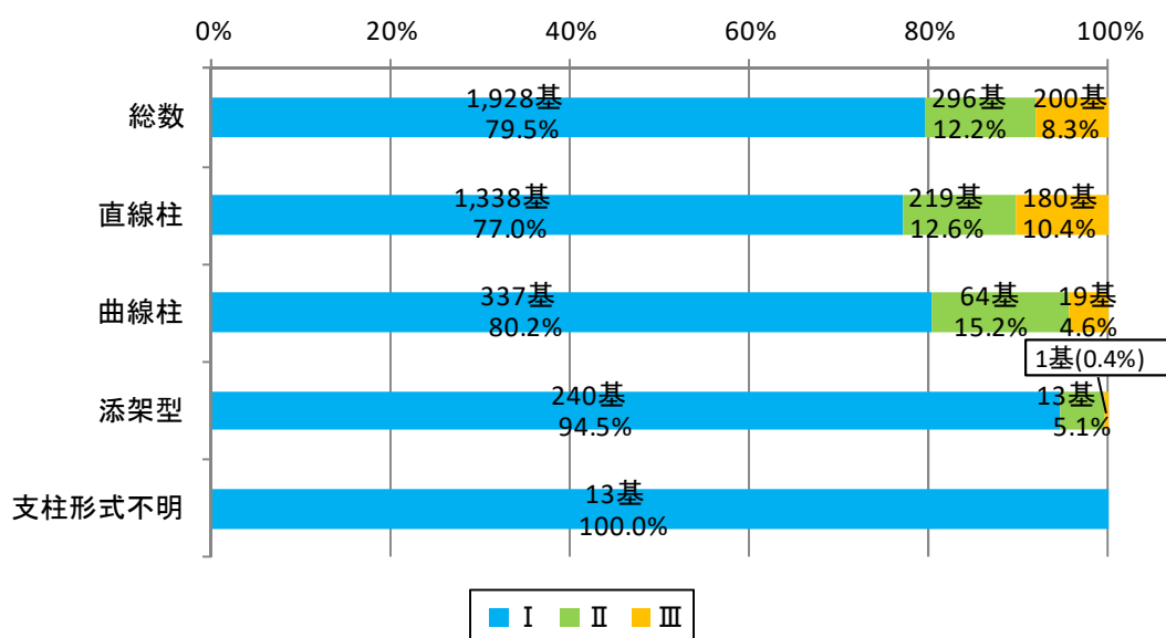
図 3.17 支柱形式別の健全度
